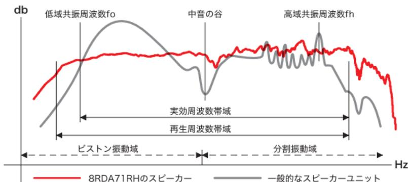
日常生活での“ながら聴き”に最適な心地よい音色を追求しました。独自開発した台形断面スピーカーボックスの音響効果により、一般的なスピーカーでは避けられない周波数特性上のピーク/ディップ(山/谷)が少ないフラット&スムーズな周波数特性を実現。これにより再生周波数特性(フラットレスポンス領域)を60Hz～20kHzまで確保。再生周波数帯のほぼ全域にわたって素直で高純度な音質を発揮し、長時間聴いても耳疲れしない、心地の良い音を再現しています。
