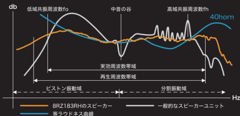
8RDA71RHの全音域フラットな周波数特性をベースに、人の耳の感覚的な音の大きさを表す「等ラウドネス曲線」にスピーカーの特性を合わせました。それにより、人の聴覚に合ったより心地の良い音を実現しています。また、音楽・映像制作をはじめとするプロオーディオの現場でトップシェアのWaves社MAXX AUDIO®を搭載。バーチャルウーハー、ツイータ効果により、フラット音域をさらに拡大しました。また自動音量調整技術により、音の大きさが音質が劣化することなく豊かな音を楽しめます。
